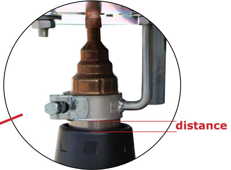
**V.** Vous pouvez aussi varier la position du pistolet à air chaud à la surface du plateau de soudure. Utilisez la clé mixte de 13mm (n° **4**) pour desserrer l'écrou. Repositionnez le pistolet au long du trou et resserrez-le à la main.
